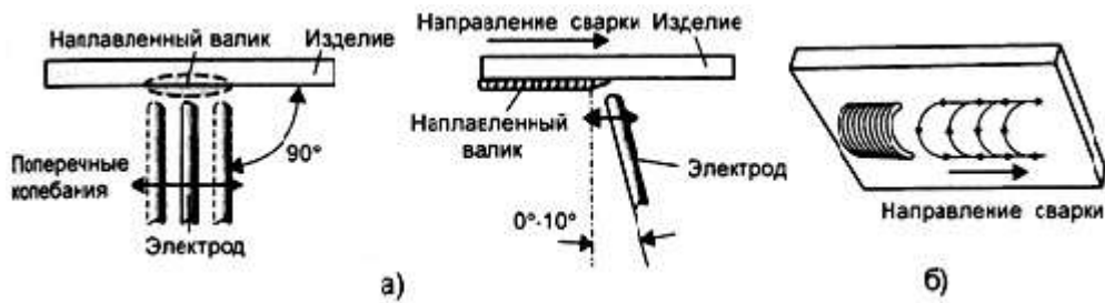
Рис.6.21 Положение электрода при наплавке валиков в потолочном положении с поперечными колебаниями электрода (а) и траектория движения электрода (б).
